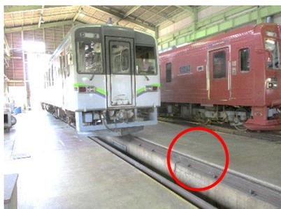
ひずみゲージ設置箇所
